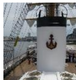
煙突の錨マークは傾斜計
