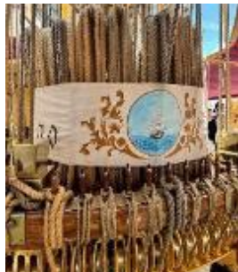
縦のロープが全て滑車を通して、ビレイピンへ：ロープは伝統的な麻製
