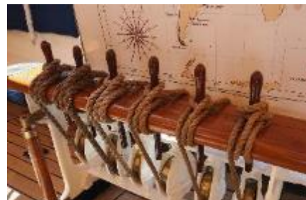
縦のロープが全て滑車を通して、ビレイピンへ：ロープは伝統的な麻製
